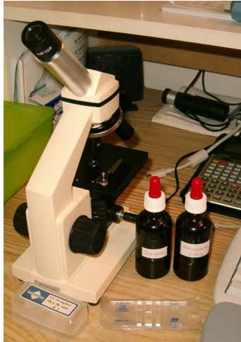
Bild9. Mikroskop, cellkammare, jodsprit och metylenblått
